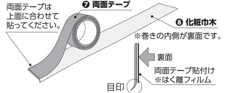
**10** ⑦ 両面テープ のはく離フィルムの端を少しずつ剥がしながら慎重にフロアアップベースに貼付けます。 ※ ⑧ 化粧巾木 と床の接する部分は床とのスキ間を作らないように貼ってください。
