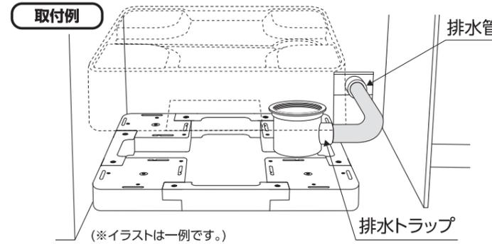
**7** 床に固定したフロアアップベースの上に床上点検洗濯機防水パンUSB-7464を重ねて取付けます。(※取付け用部品は防水パンに同梱されています)
