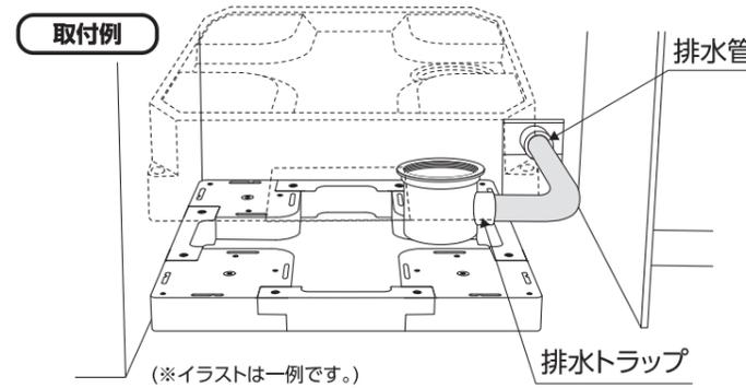
**7** 床に固定したフロアアップベースの上に床上点検洗濯機防水パンUSB-6464を重ねて取付けます。(※取付け用部品は防水パンに同梱されています)
