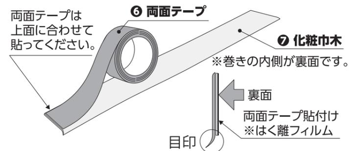
**10** ⑥ 両面テープ のはく離フィルムの端を少しずつ剥がしながら慎重にフロアアップベースに貼付けます。 ※ ⑦ 化粧巾木 と床の接する部分は床とのスキ間を作らないように貼ってください。
