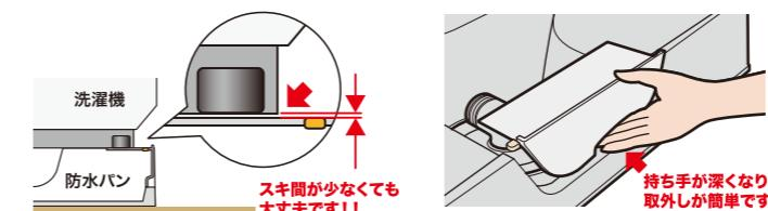
※防水パンのお手入れやカバーを外して洗濯機の下に手を入れるときは洗濯機が停止していることを確認し、洗濯機の電源のコンセントを抜いて安全を確認してから行ってください。
