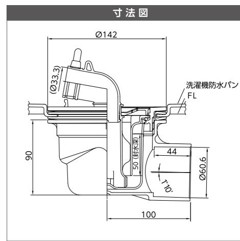
※透明トラップ(CTタイプ)に比べて配管との接続位置を下げる為、床の厚み※がある場合に適しております。
